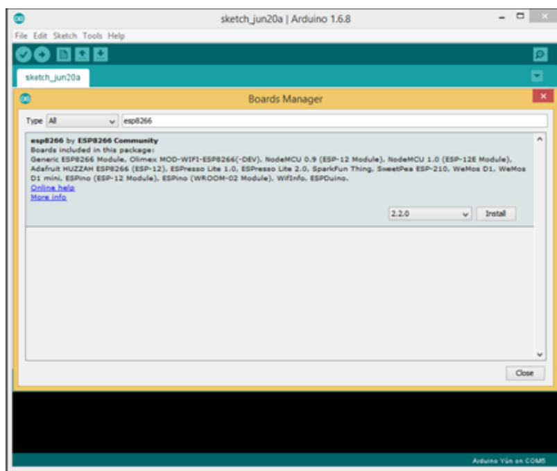
ภาพที่ จ-16 การติดตั้ง ESP8266
