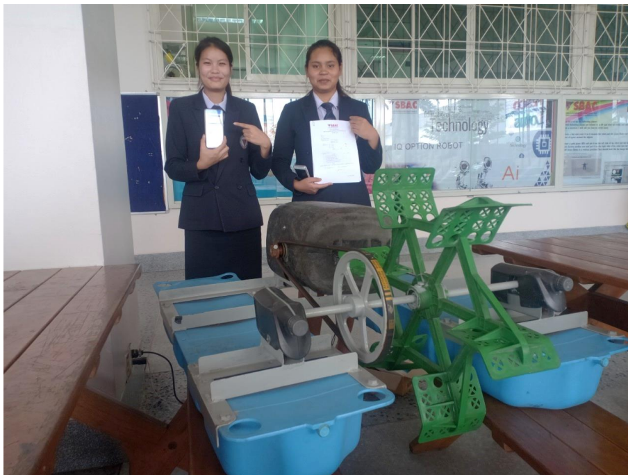
ภาพที่ ง-7 กังหันน้ำแรงเหวี่ยงเต็อนค่าออกซิเจนผ่านคลาวด์เทคโนโลยีเพื่อบำบัดน้ำเสีย ในบ่อเลี้ยงกุ้ง
