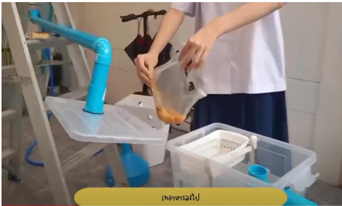
ภาพที่ จ-6 นวัตกรรมเครื่องกรองไขมันจากเศษอาหาร
