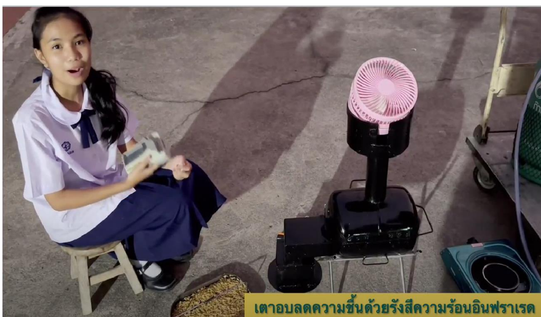
ภาพที่ จ-4 นวัตกรรมเตาอบลดความชื้นด้วยรังสีความร้อนอินฟราเรด
