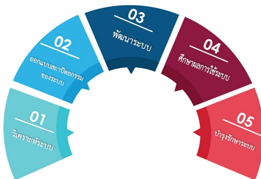
ภาพที่ 3-1 ภาพวงจรการพัฒนาระบบ (System Development Life Cycle : SDLC)
