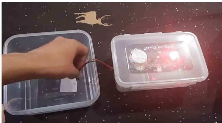
ภาพที่ จ-4 โครงการวิศวกรรมอิเล็กทรอนิกส์ เครื่องแจ้งเตือนน้ำล้น
