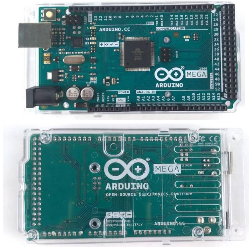
ภาพที่ 4-11 แสดงอุปกรณ์บอร์ดไมโครคอนโทรลเลอร์ ARDUINO MEGA 2560
