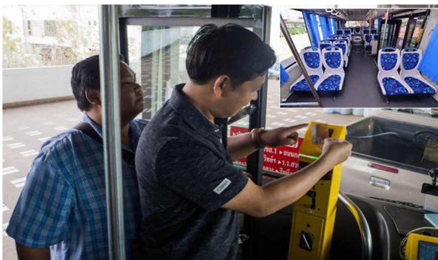
ภาพที่ 2-12 การหยอดเหรียญอัตโนมัติและจ่ายด้วยบัตรสมาร์ทการ์ด (บัตร RFID)
