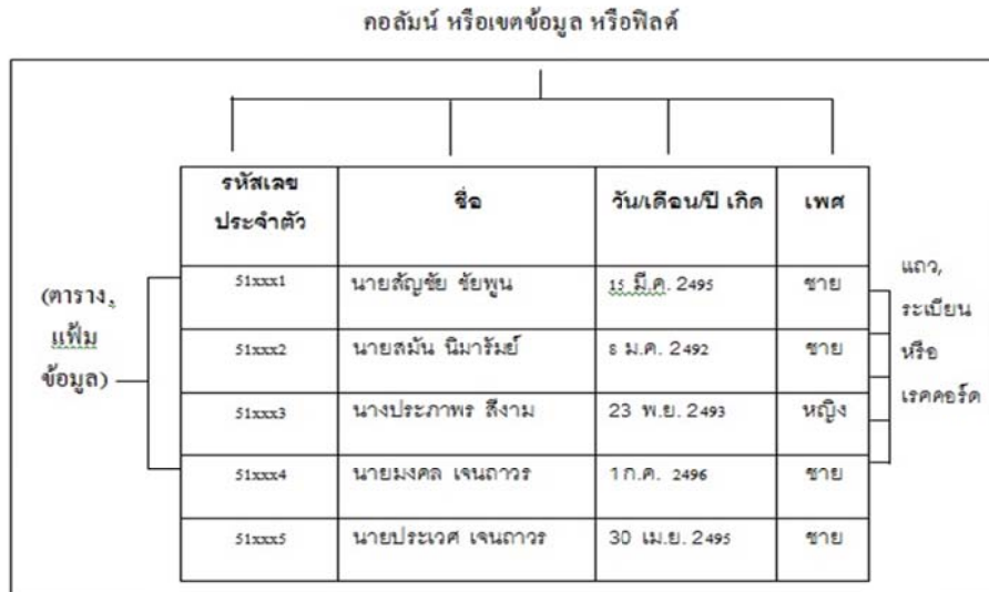
ภาพที่ 2-1 แฟ้มข้อมูล คอลัมน์ และเรคคอร์ด (วิเชียร, 2547)
