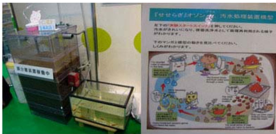
ภาพที่ 2-10 ระบบบำบัดน้ำจากห้องน้ำและการซักผ้าโดยสามารถหมุนเวียนน้ำใสกลับมาใช้ใหม่เป็นแนวคิดใหม่ของประเทศญี่ปุ่น (เดช, 2551)
