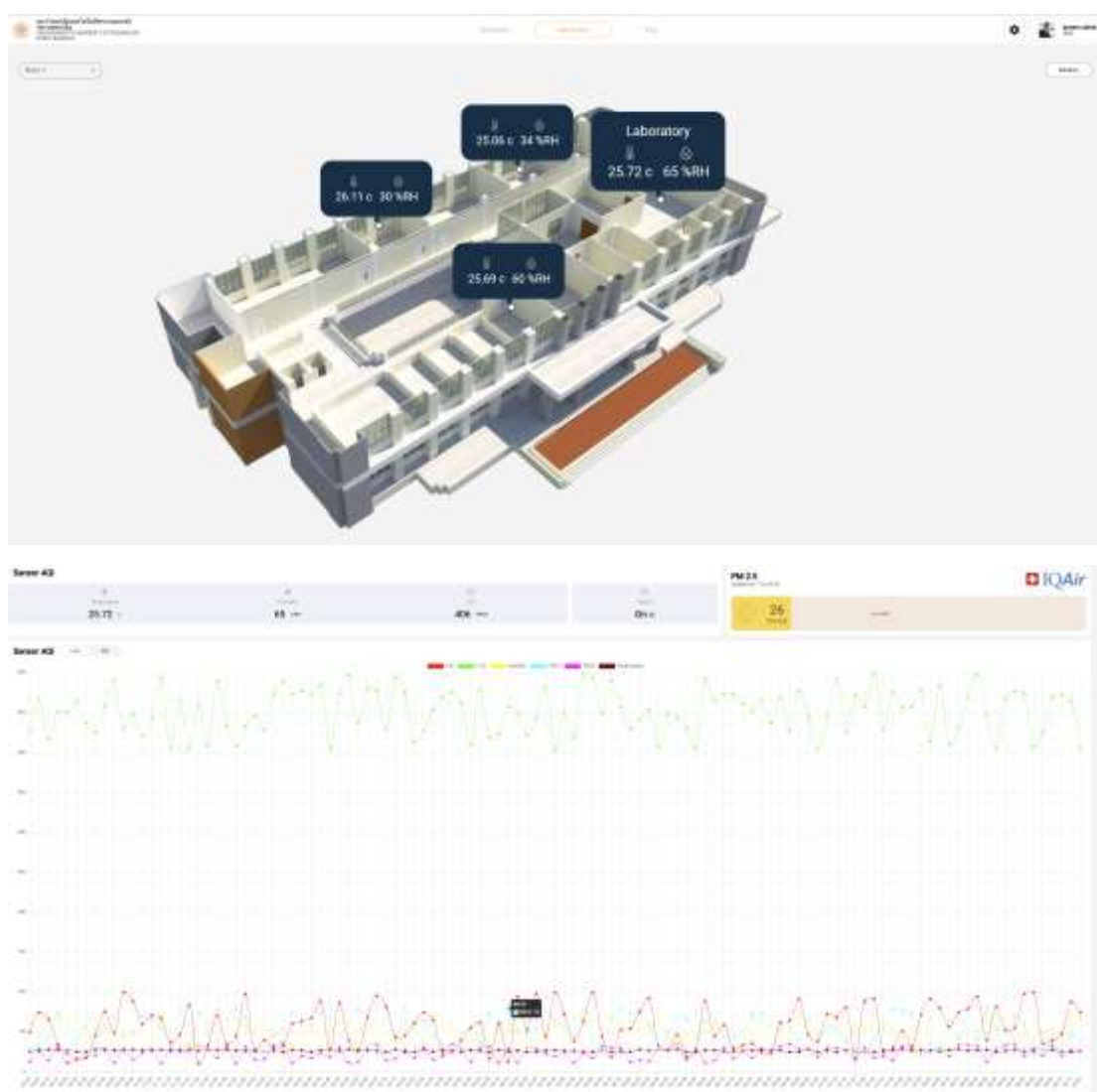
ภาพที่ 5-5 การแสดงข้อมูลการตรวจวัดสภาพแวดล้อมของแต่ละห้องบนชั้น 1
