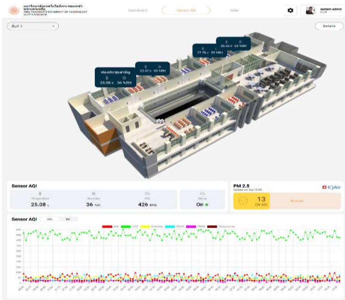
ภาพที่ 4-6 แดชบอร์ดแสดงผลพลังงานคู่แฝด ในชั้นที่ 3 ของอาคาร
