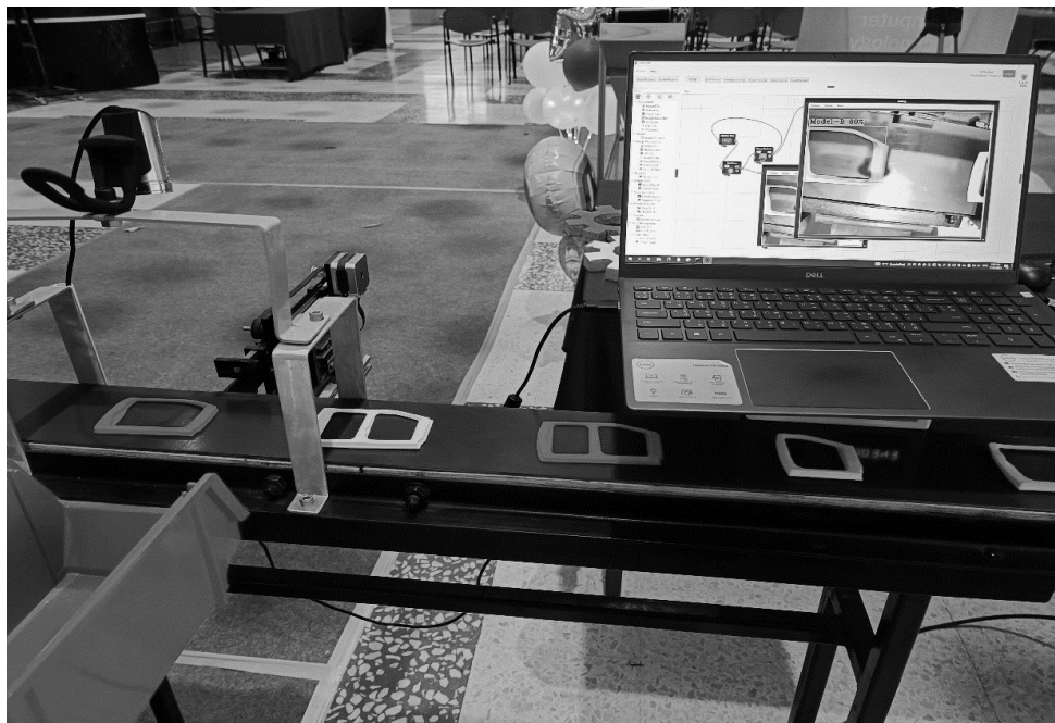
ภาพที่ ค-2 ระบบตรวจสอบชิ้นงานการผลิตชิ้นส่วนยานยนต์ด้วยเทคโนโลยีการประมวลผลภาพ ด้วยโปรแกรม Cira core 2
